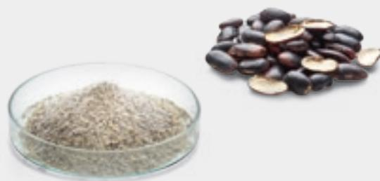
Homogene Probe: Bohnen vor und nach der Mahlung mit der Rotor-Schnellmühle PULVERISETTE 14
