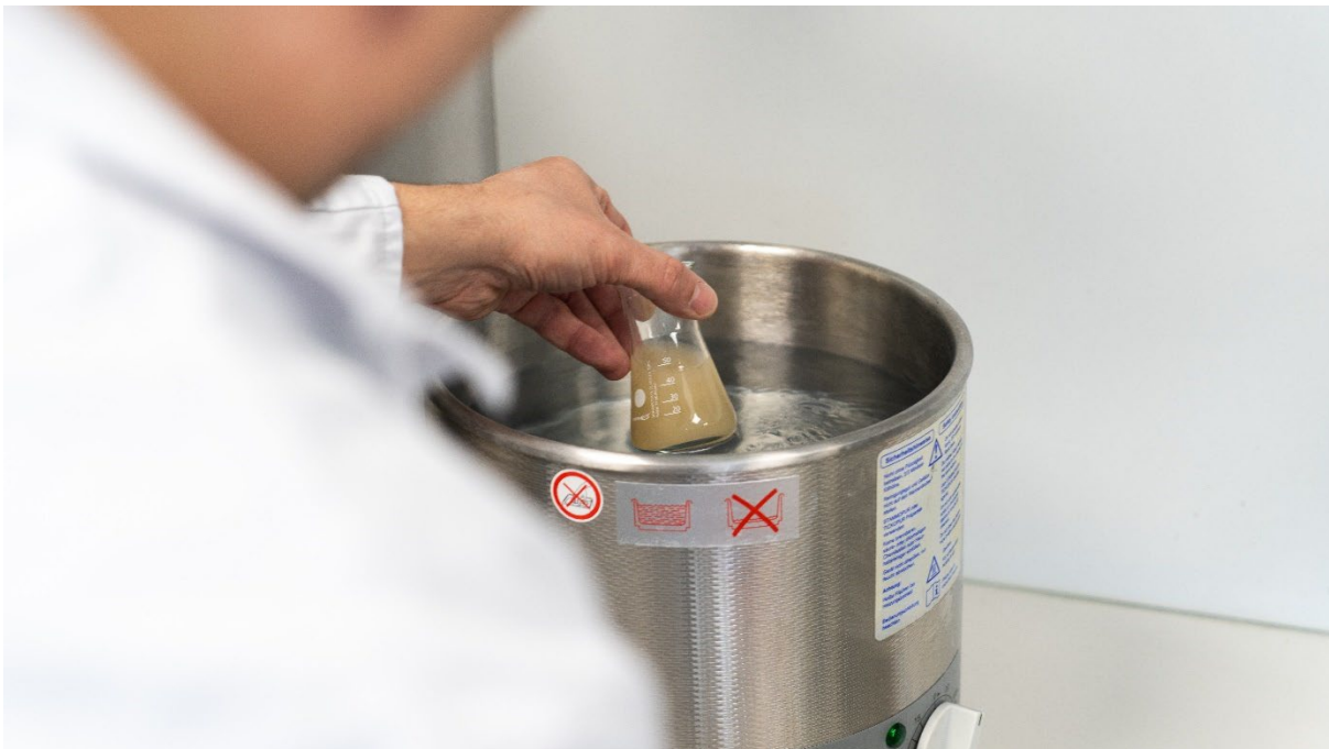
Abb. 1: Vordispergierung der Probe im Ultraschallbad
