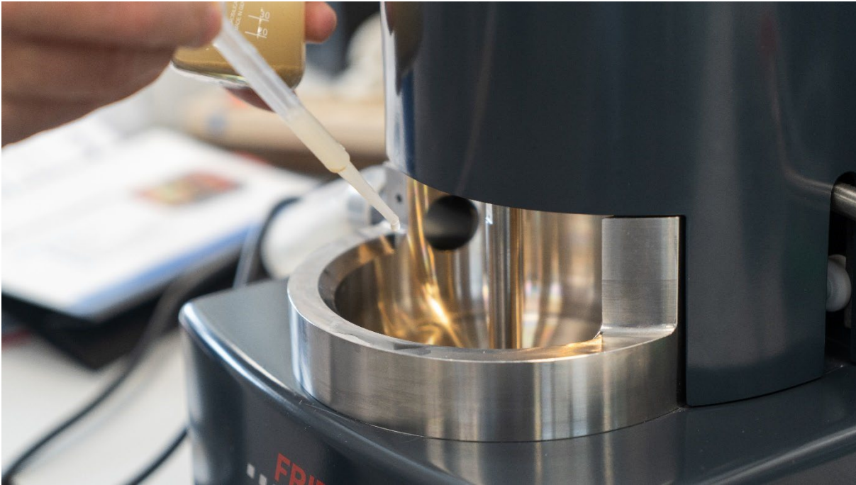
Abb. 2: Pipettieren der vordispersierten Probe in die Nass-Messeinheit der A-22 NeXT
