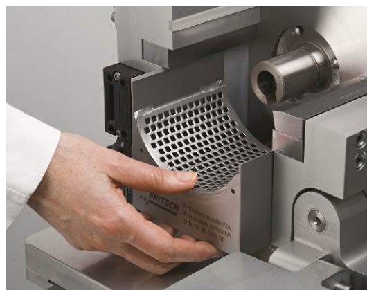
Abb. 1: geöffneter Mahlraum – FRITSCH Schneidmühle
