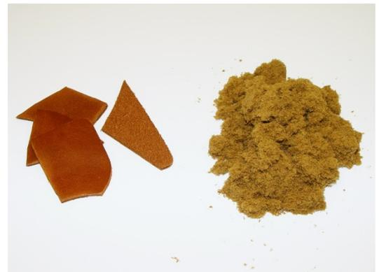
Abb. 2: Leder Probe nach der Mahlung mit der FRITSCH Schneidmühle PULVERISETTE 15
