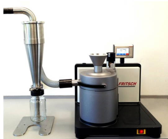
Abb.4: PULVERISETTE 14 premium line mit Edelstahlzyklon umgerüstet für die Zerkleinerung von größeren Mengen
