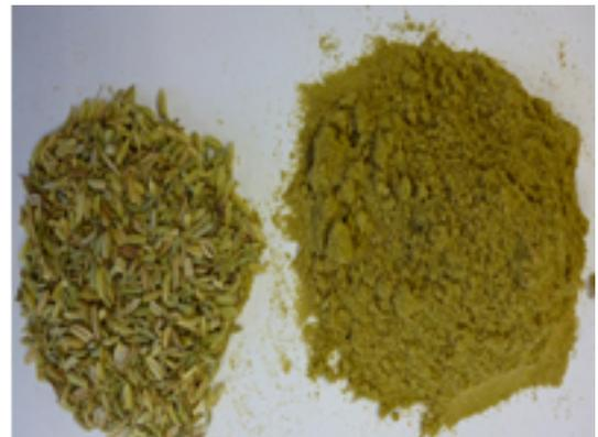
Fenchel zerkleinert mit der PULVERISETTE 19
