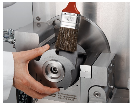
Abb.2: Mahlwerkzeuge lassen sich mit nur einem Handgriff herausnehmen für eine einfache Reinigung
