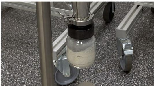
Abb. 3: Probenaustrag im Probenglas am Zyklon
