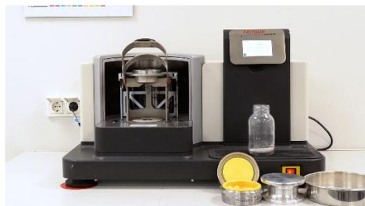
Abb.: 4: PULVERISETTE 5 *premium line* mit ZrO<sub>2</sub> Zubehör
