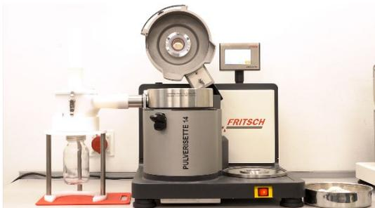
Abb. 4: PULVERISETTE 14 *premium line* mit Kleinmengenzyklon
