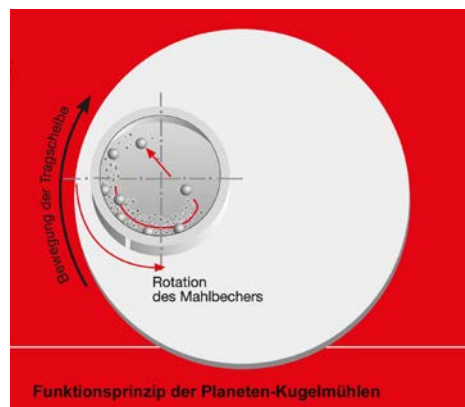
Abbildung 1. Planeten-Kugelmühle PULVERISETTE 7 premium line von Fritsch GmbH sowie allgemeines Funktionsprinzip von Planeten-Kugelmühlen.
