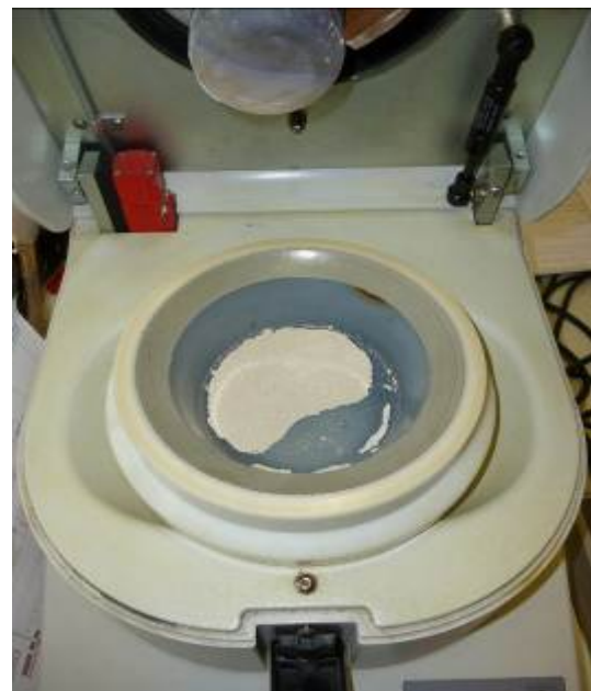
Abb. 2: 20 g Sand gemahlen mit der P-2 nach 30 min, Achatgarnitur
