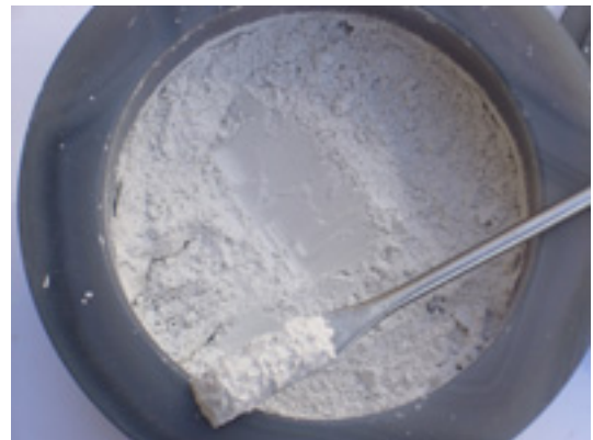
Abb. 3: 100 g Quarzsand 5 min gemahlen, P-6, 250 ml Achatmahlbecher, 20 mm Kugeln
