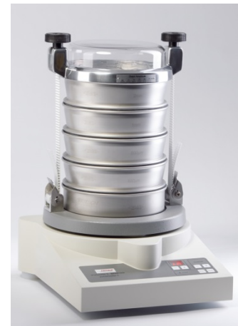
Abb. 2: PULVERISETTE 0 umgerüstet zur Vibrations-Siebmaschine
