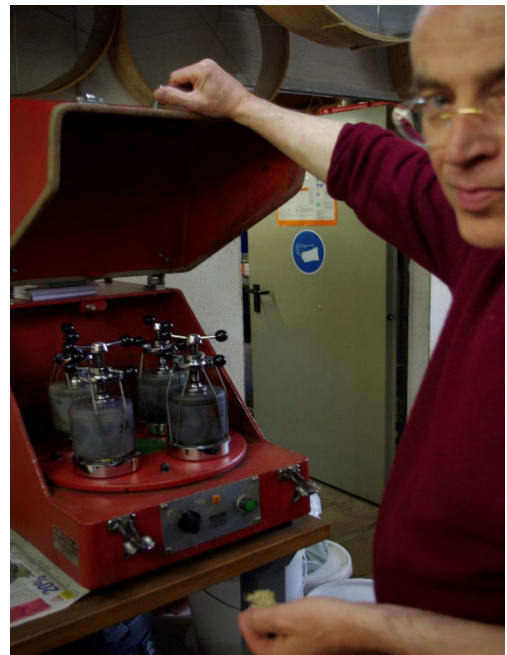
Abb. 3: Dr. Kremer beim Einsatz der Planeten-Kugelmühle PULVERISETTE 5
