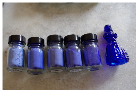
Abb. 2: Pigment in verschiedener Teilchengröße
