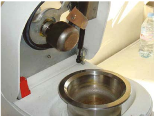
Abb. 1: PULVERISETTE 2 mit Mörserschale aus rostfreiem Stahl
