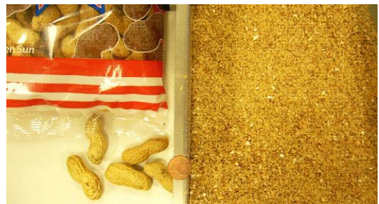
Abb. 6: Erdnüsse zerkleinert mit einem 4 mm Sieb
