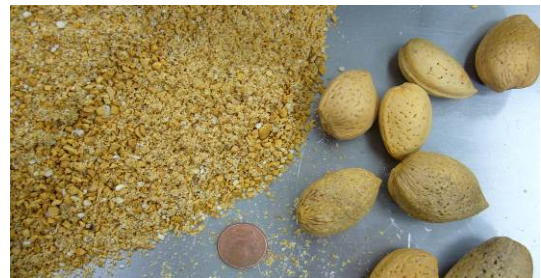
Abb. 5: Mandeln zerkleinert mit einem 4 mm Sieb
