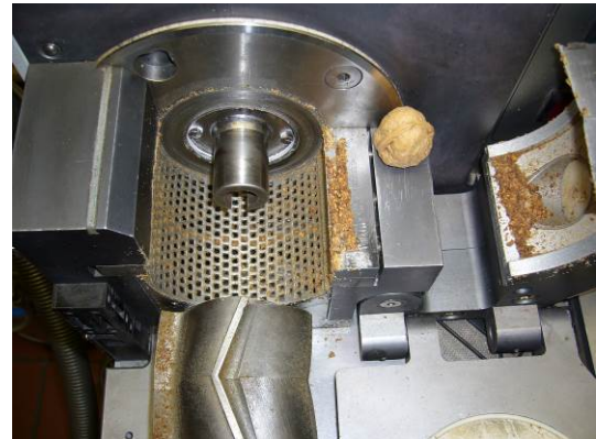
Abb. 4: der Blick in die geöffnete Mahlkammer zeigt einen optimalen Durchsatz der Walnüsse
