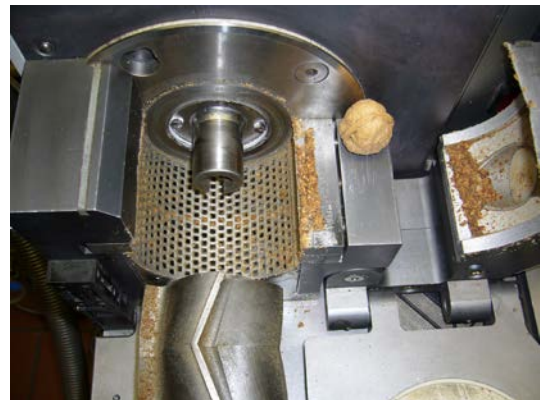
Abb. 3: der Blick in die geöffnete Mahlkammer zeigt einen optimalen Durchsatz der Walnüsse
