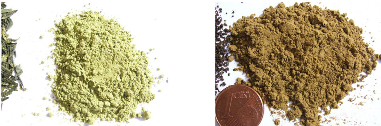
Abb. 4: Nach 3 Minuten wurden die im Bild gezeigten Ergebnisse erzielt. Sofort nach dem Öffnen der Mahlbecher wurde die Temperatur gemessen und Werte knapp unter 40°C ermittelt.
