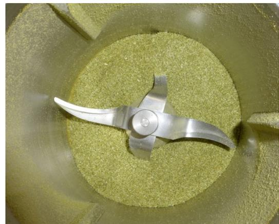
Abb. 2: Hopfen gemahlen bei 4.000 U/min, Mahldauer 15 Sekunden
