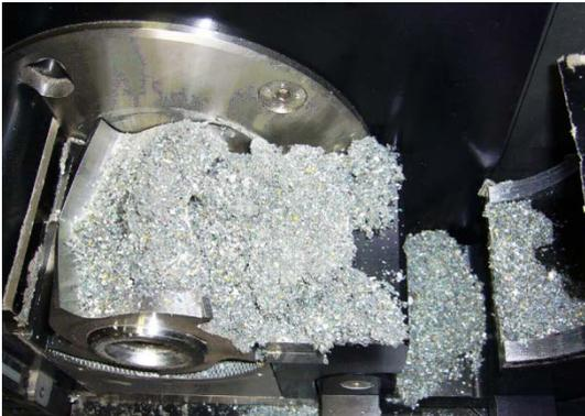
Abb. 1: Nach der Aufbereitung darf im Mahlraum der Schneidmühle nur wenig Material zurück bleiben. Keinesfalls darf es so aussehen.
