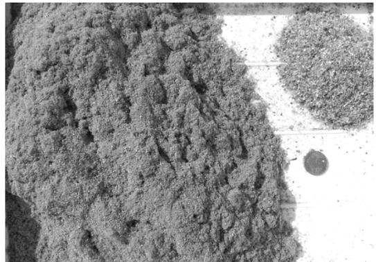
Abb. 3: Hier wurde der nicht zerkleinerte Rest ausgekehrt und liegt neben der Probe, die das Sieb passiert hat.
