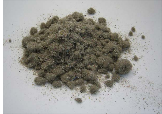
Abb. 5: nach der Mahlung – 0,5 mm Sieb
