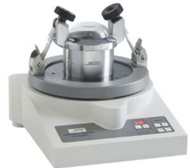
Vibrations-Mikromühle PULVERISETTE 0
