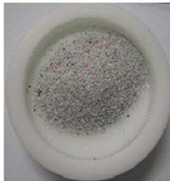
Zerkleinerung durch Versprödung unter Gefrierbedingungen
