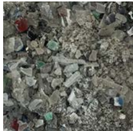
Zerkleinerung durch Versprödung unter Gefrierbedingungen
