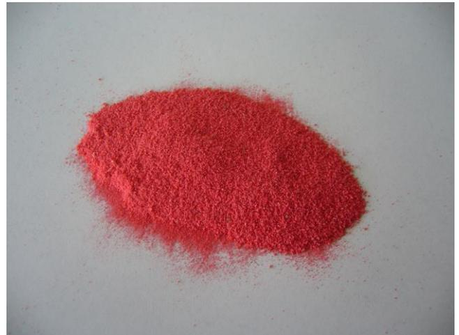
Abb. 4: Analysenfeinheit nach Mahlung mit der PULVERISETTE 14 *classic line*
