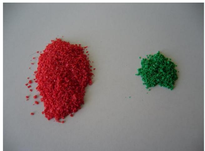
Abb. 3: Vorzerkleinerung mit der PULVERISETTE 19, 2 mm Sieb
