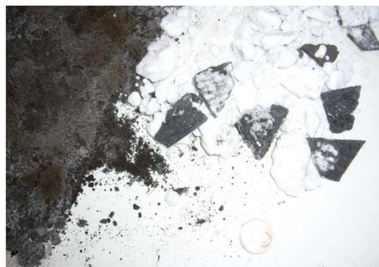
Abb. 2: Probe zerkleinert gemischt mit Trockeneis
