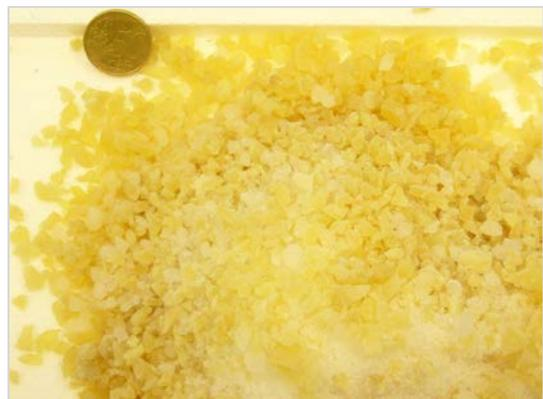
Abb. 2: Mit Trockeneis verarbeiteter Kautschuk: Diese Verarbeitung verhindert eine Verklebung des Granulats und dieses bleibt somit fließ- bzw. schüttfähig
