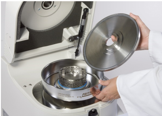
Abb. 1: Innenansicht einer Rotor-Schnellmühle PULVERISETTE 14 classic line mit variabler Drehzahl, mit Auffanggefäß, Rotor und Siebring. Rechtes Bild: Der Hochleistungszyklon aus rostfreiem Edelstahl
