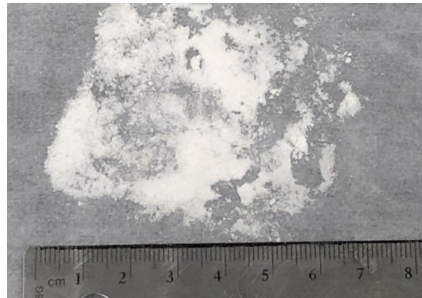
Abb. 2: Links das Schneidmühlensystem PULVERISETTE 19, mit Hochleistungs-Zyklon, der auf einem 60-Liter-Auffanggefäß montiert ist. Bild rechts: CBD-Isolat, das mit der Universal-Schneidmühle PULVERISETTE 19 bis in den unteren bis mittleren Mikron Bereich homogenisiert wurde.
