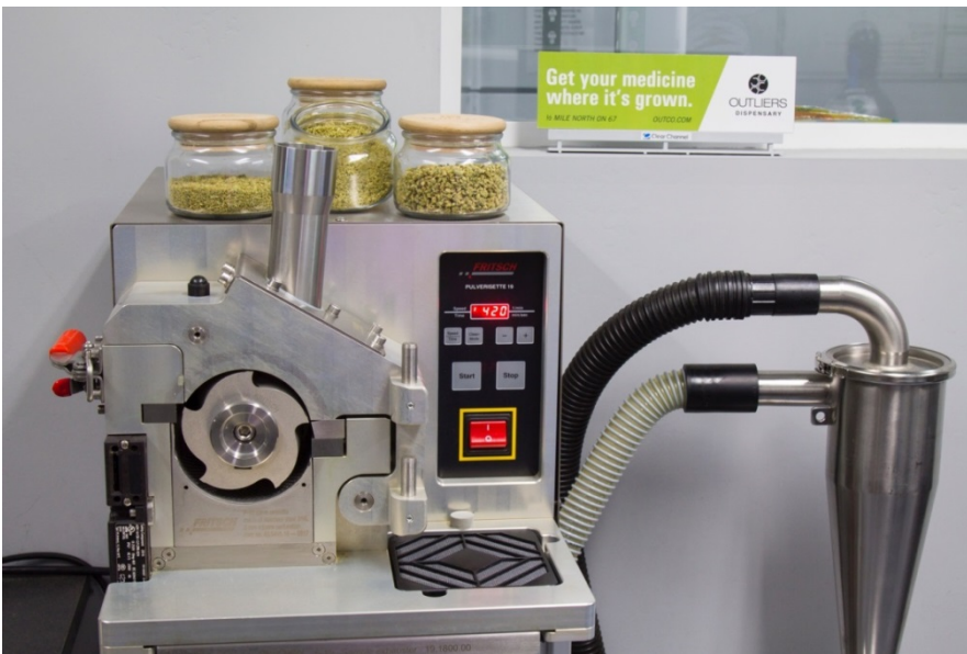
Abb. 2: Universal Schneidmühle PULVERISETTE 19 und gemahlene Cannabis Proben
