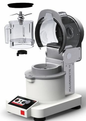
Abb. 5: Messermühle PULVERISETTE 11
