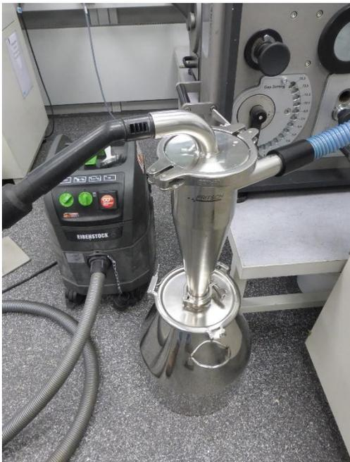
Abb. 3: Zyklon mit Staubsauger und 20 Liter
