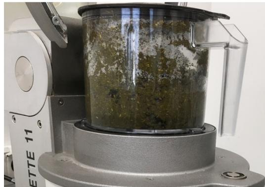
Abb. 3: Trockene sowie feuchte Proben können in der Messermühle PULVERISETTE 11 zerkleinert werden
