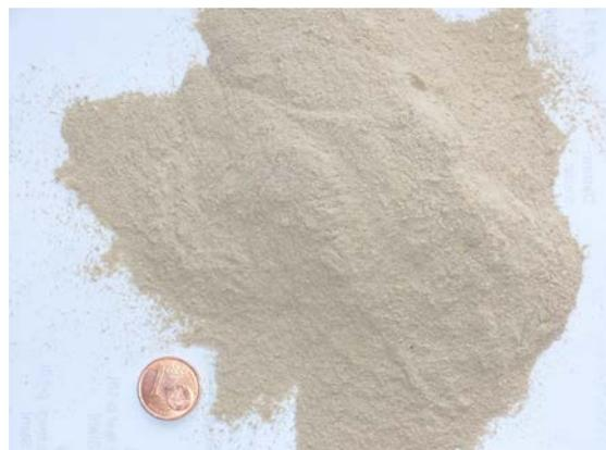
Abb. 2: Probe nach 10 Minuten Mahlung
