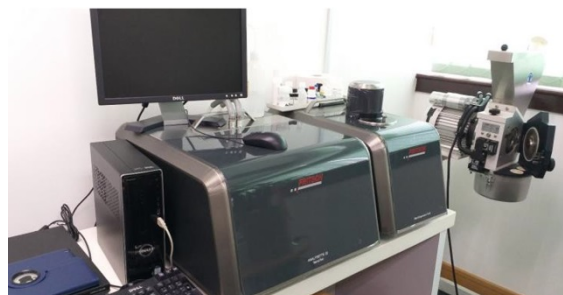
Abb. 3: Laser-Partikelmessgerät ANALYSETTE 22 und Schlagkreuzmühle PULVERISETTE 16
