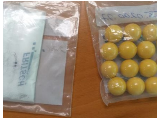
Abb. 7: Mahl­kugeln 0,1 mm und 10 mm
