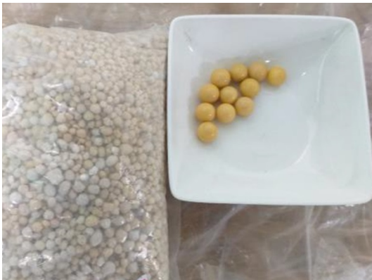
Abb. 6: Probe Kieserite Dünger und Mahl­kugeln 10 mm
