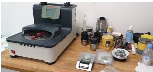
Abb. 2: Planeten-Mikromühle PULVERISETTE 7 premium line und Zubehör
