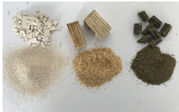
Abb. 4: Kunststoff-, Holz- und Futterpellets-Probe: Zerleinert mit dem Rotor mit gekerbten Schneiden und einer Siebkassette 0,75 mm Trapezloch
